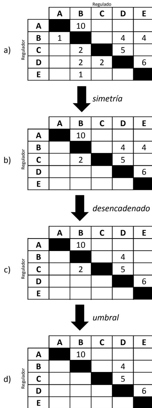
Figura 5.4: Aplicación de las reglas a partir de la matriz PS. a) Matriz de puntuación *Original*. b) Matriz resultante luego de la aplicación de la regla *Simetría*. c) Matriz resultante luego de la aplicación de la regla *Desencadenado*. d) Matriz resultante luego de la aplicación de la regla *Umbral*.
